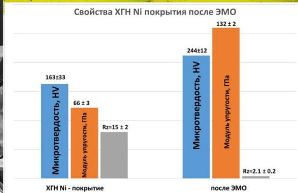
В лаборатории №5 реализован и исследован уникальный подход к постобработке покрытий, полученных холодным газодинамическим напылением (ХГН), что соответствует СНТР РФ по направлению Н1 «Переход к передовым цифровым, интеллектуальным производственным технологиям, роботизированным системам, новым материалам и способам конструирования, создание систем обработки больших объемов данных, машинного обучения и искусственного интеллекта».
